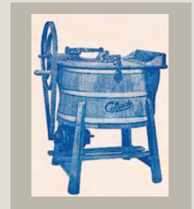
Figure18. Une des versions de la machine à laver, ici motorisée. Il fallait prévoir le foyer pour faire bouillir l'eau.
